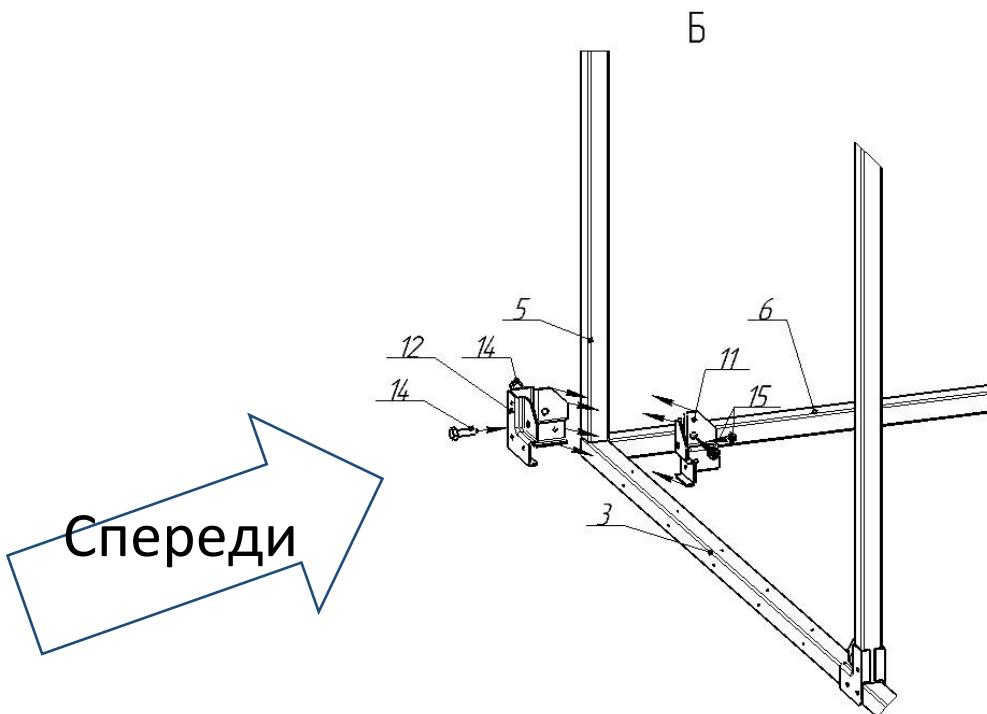
После соединения каркаса крабами измеряются диагонали нижней части сарая, разница диагоналей не должна превышать 5мм.
