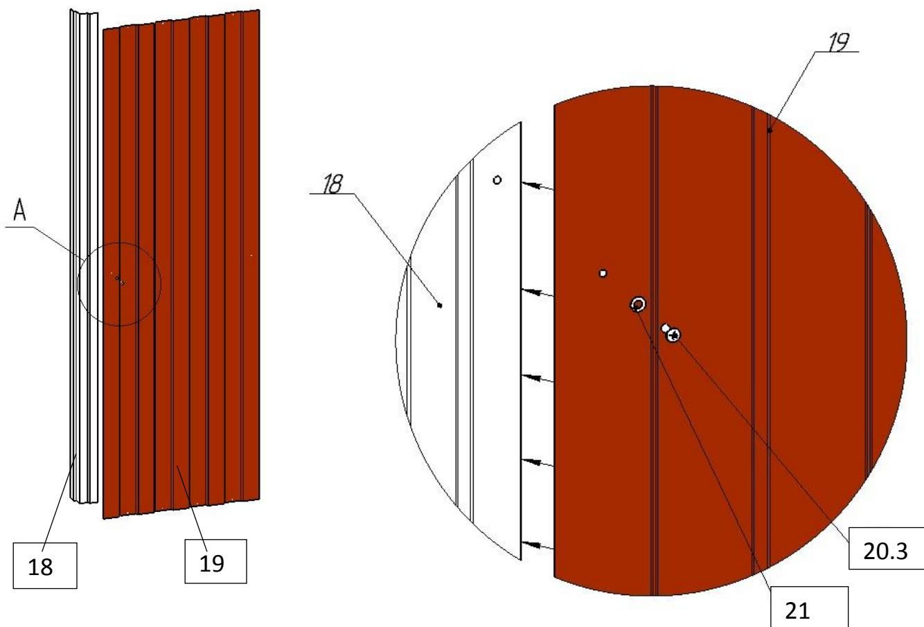
Примечание: стеновой профлист (поз.19) крепится поверх уголка (поз.18).
