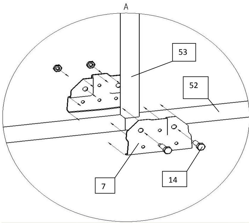
Аналогично производится крепление элементов поз.52 и поз.53 в верхней части каркаса.
