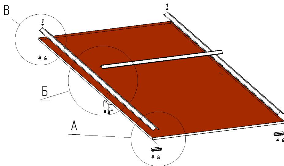
Для крепления всех элементов на двери предусмотрены отверстия. На все винты накручиваются шайбы (поз.20.3)
