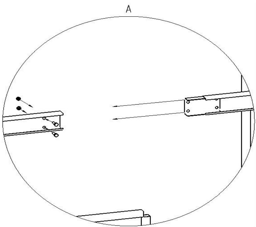
Присоединяем элементы поз.52 и поз.53 к каркасу сарая с помощью Т-краба поз.7.
