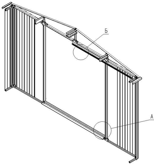
4.1 Соединяем между собой 2 части порожка (поз.33) и крепим к нижней трубе дверного проема саморезами (поз20.2):
