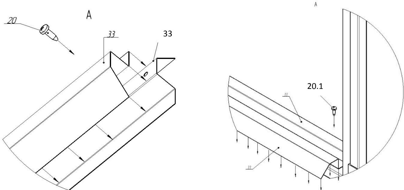
**4.2 С обеих сторон порога во внутренней части сарай крепим направляющий профиль (поз.41) саморезами-сверлами (поз.20.1). Данный профиль является направляющим для дверей.**
