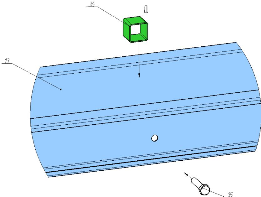
Вид Г. Крепим предварительно собранные кровельные профили (поз.13) к вертикальной балке (поз.2), подложив крепежные оцинкованные уголки (поз 27). Перфорация на профилях должна быть расположена кверху. Крепление производится болтами (поз.16).
