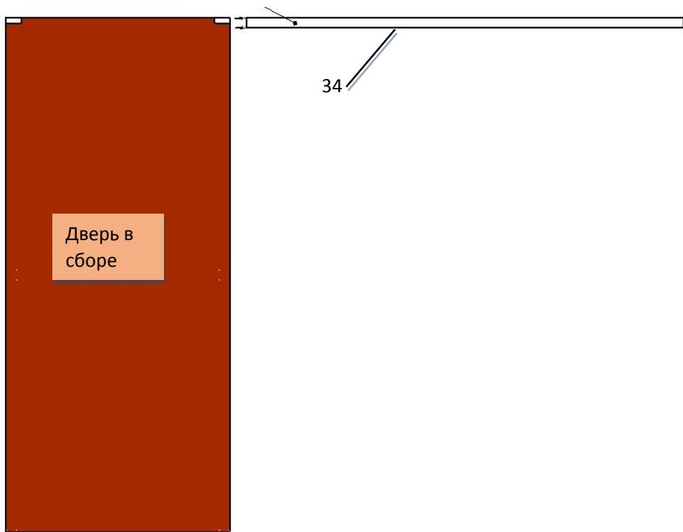
Двери с направляющими поднести к дверному проему с внутренней стороны сарая, устанавливаем двери в направляющие снизу (поз.41).
