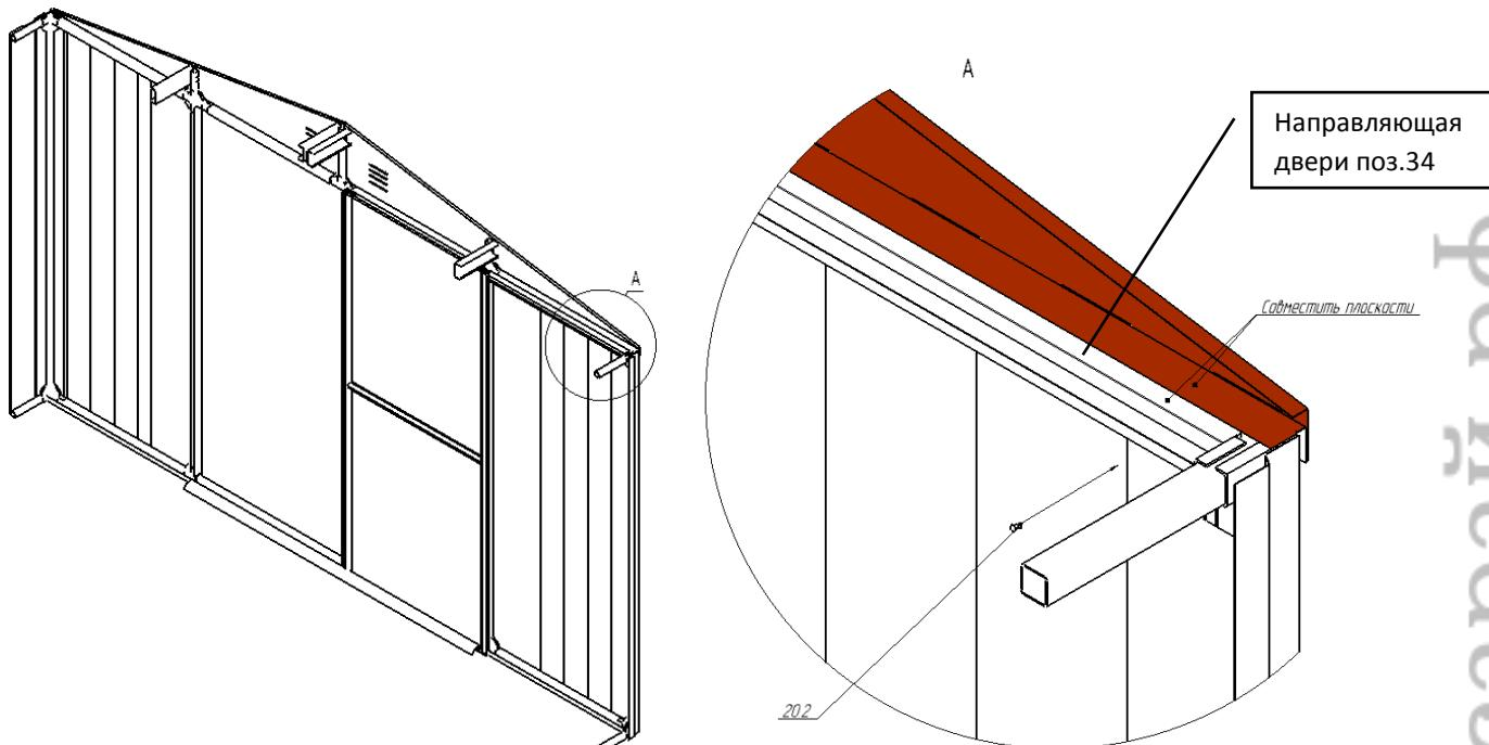
Затем переводим дверь в крайнее правое положение, устанавливаем уровень строительный на направляющий профиль (поз.24), выставляем по горизонту, заводим ограничитель хода дверей (поз.45) и прикручиваем саморез (поз20.2)
