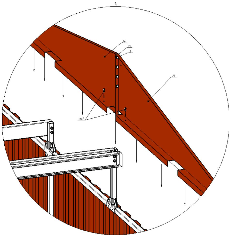
Крепим с лицевой части сарая фронтоны (поз 25) и (поз 26) к уголкам на центральной балке саморезами – сверлами (поз.20.1), подложив под них шайбы пластиковые.
