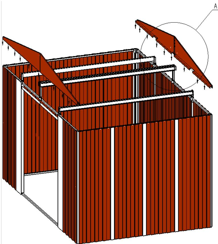
Вид. А. Устанавливаем фронтоны на каркас и прикручиваем саморезами-сверлами (поз20.1).
