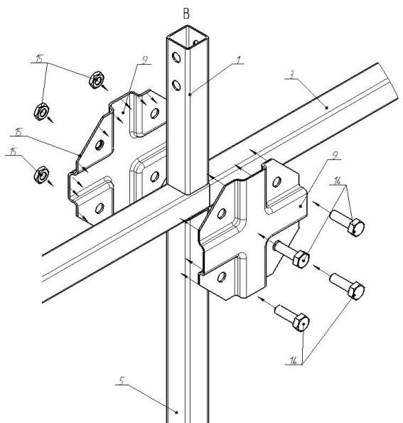
Вид Г. Крепление стойки кровельной балки (поз.2 ).
