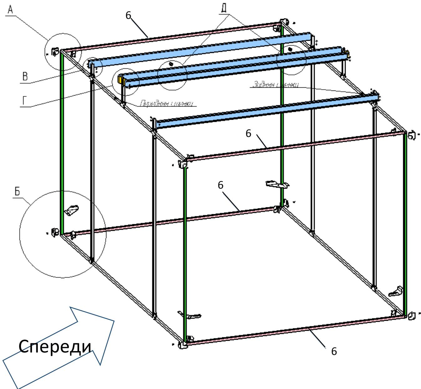
**1.3.1 Вид А.** Соединение верхнего пояса каркаса сарая (4 соединения). Используется краб XYZ, состоящий из внутренней и наружной частей (поз.11) и (поз.12)
