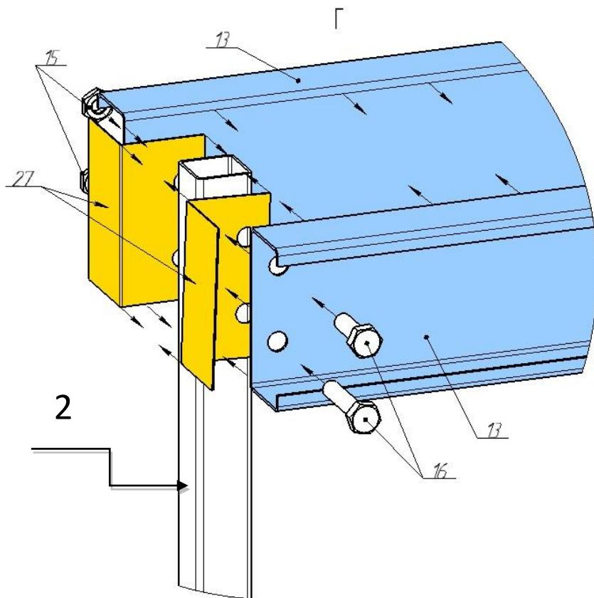
После этого производим окончательную затяжку всех болтов (поз.16), соединяющих кровельные профили.
