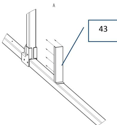
2. Прикрепляем белый доборный элемент (поз.17) через подготовленные отверстия. Крепление производится саморезами (поз.20.1) с шайбами (поз.21)
