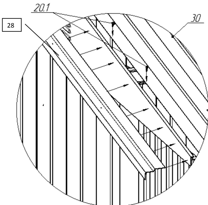
Вид Б. Крепим белую планку (поз.29) на край крыши саморезами-сверлами (поз20.1). подкладываем шайбы (поз.21).
