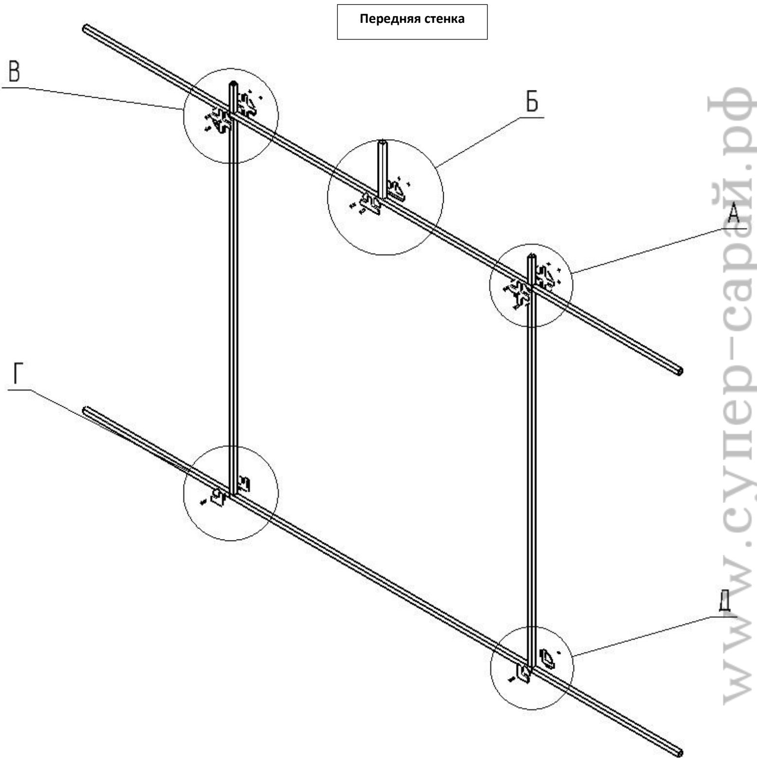
На эскизе представлен общий вид данной стенки. Сборку элементов необходимо производить в соответствии с эскизами А, Б, В, Г, Д.
